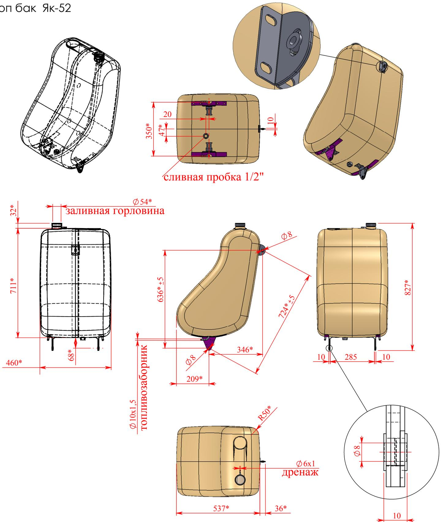
Дополнительный топливный бак самолета Як-52
