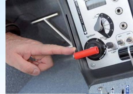
Démarrage possible seulement si le sélecteur carburant est sur « ouvert ».
