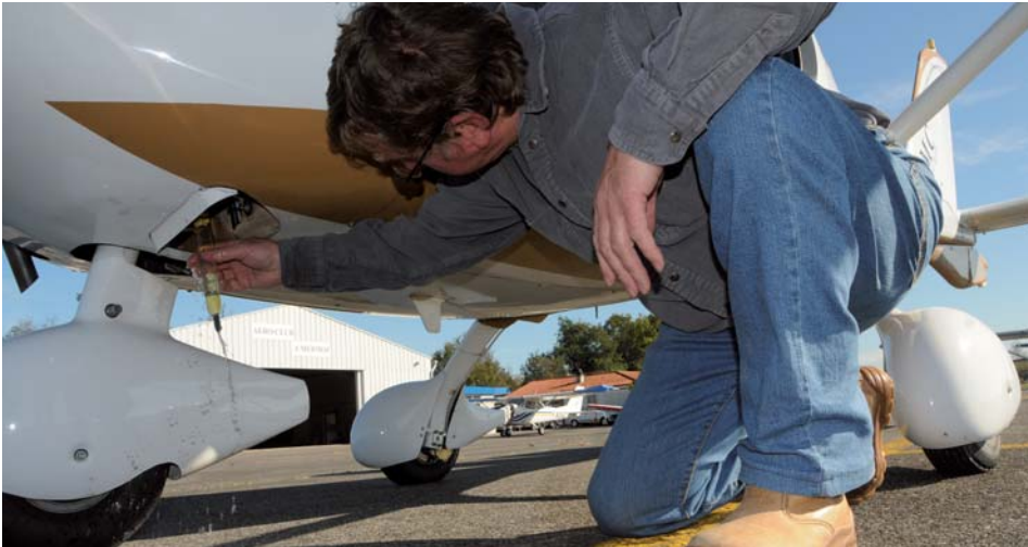
La purge se fait en un seul point central au niveau du train avant.
