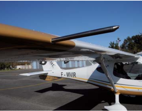
Le tube pitot prend aussi les pressions pour l'incidencemètre. En bas : sabot de protection de queue.
