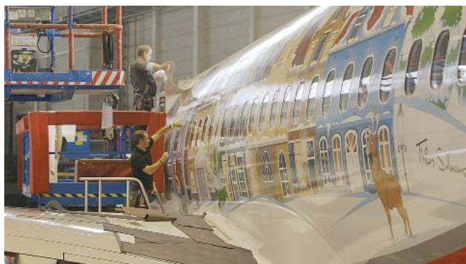
Boeing 737 в процессе оклеивания пленкой Orajel 3967
